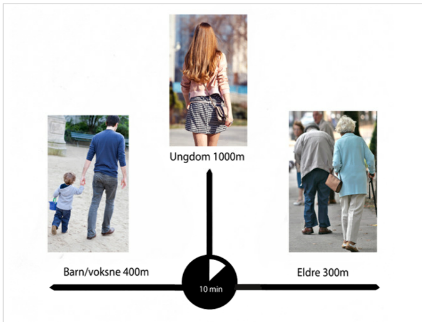
Figur 5.2.5.1. Gangavstanden ulike aldersgrupper tilbakelegger på 10 minutter (basert på tall fra «Planlegging av grønnstruktur i byer og tettsteder», Direktoratet for naturforvaltning 6-1994).
